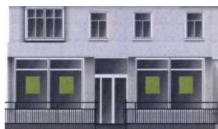
■ Места размещения информационных блоков в светопрозрачных конструкциях
